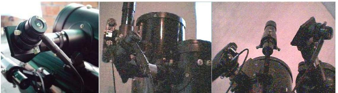
el ocular reticulado montado, también se ve un cable que sale de la cámara fotográfica, este es el cable disparador, con se abre y se cierra el obturador sin tocar la cámara por medio de una guaya interna, lo mantenemos abierto usando un tornillo que sujeta la guaya y lo cerramos cuando se afloja el tornillo, pero en el momento que se abre el obturador y cuando lo cerramos el telescopio vibra mínimamente por unos segundos a causa del movimiento del obturador, por esto tengo que
