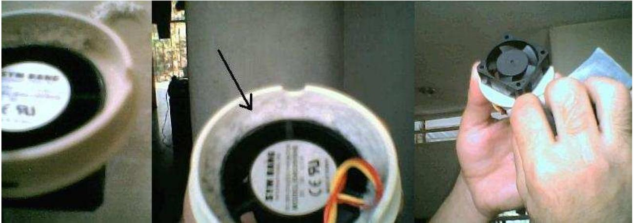
Ponemos la tapa en la cámara lijamos al ras cualquier sobrante, y cubrimos el ventilador y el enchufe USB con tirro de algún tipo, y lo pintamos con spray negro Brillante.
