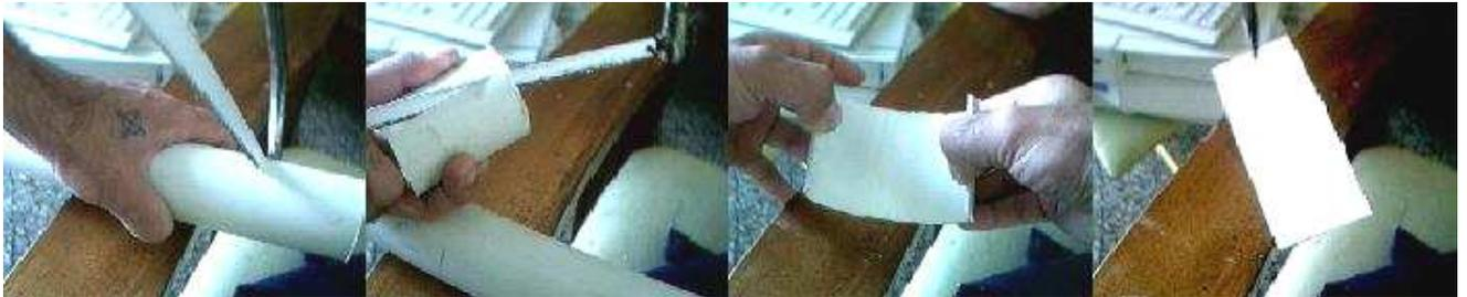
Cortan un cuadrado, lo calientan en la cocina, lo aplanan entre dos baldosas puede ser, y lo meten en agua estando aplanado y caliente, el se queda con la forma en que se enfría, luego hacen un agujero en el centro donde van a ir probando la pieza que soporta el sensor hasta que quede ajustada y se pega de manera permanente con pega loca.
