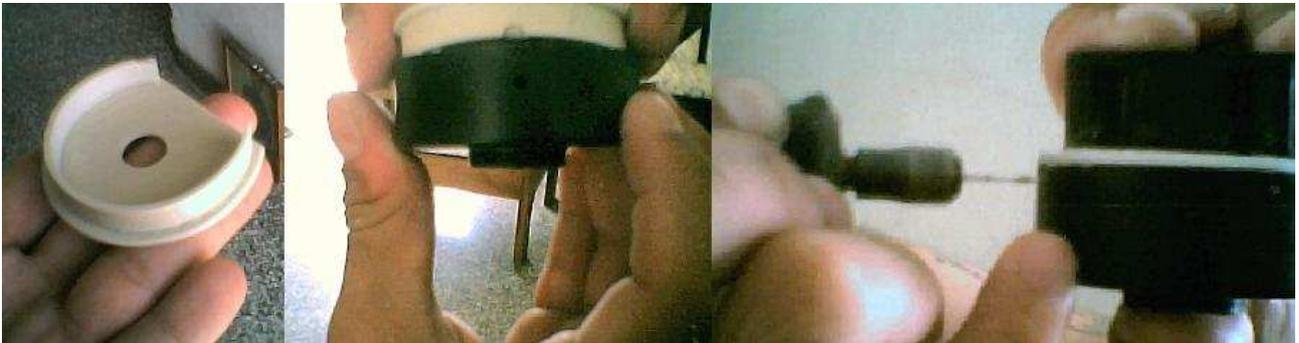
Este ventilador lo vamos a incrustar en esta tapa que hicimos desgastándole la parte que va hacia adentro de la forma que esta en la imagen del centro en la figura de abajo, el ventilador en uno de sus lados dice con unas flechitas hacia donde giran las aspas y hacia que lado sale el aire, a la tapa de la cámara le vamos a hacer un agujero en el centro donde va incrustarse el ventilador
