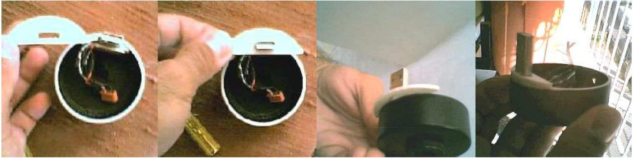
Luego hacemos la tapa de la cámara y la ensamblamos para luego lijar los sobrantes y ponerlos al ras del cilindro de la cámara, luego taladramos los agujeros para los tornillos que pueden ser los mismos que cerraban la cámara antigua, esto después de haber puesto un ventilador de 5 voltios para enfriar el sensor que alimentaremos con la misma corriente del USB.
