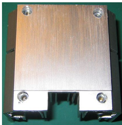
Imagen 21. Base del disipador con los 4 taladros
