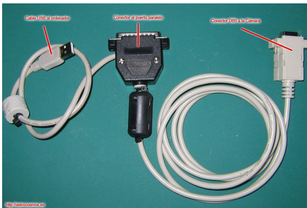
Imagen 18. Aspecto del cable terminado con todas sus conexiones
