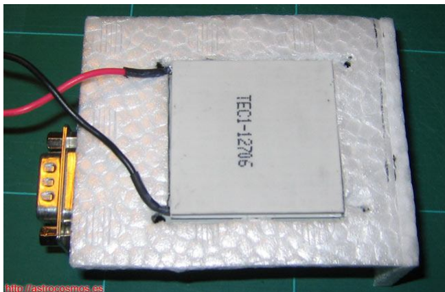
Imagen 23. Instalación de la célula Peltier sobre la carcasa de aluminio
